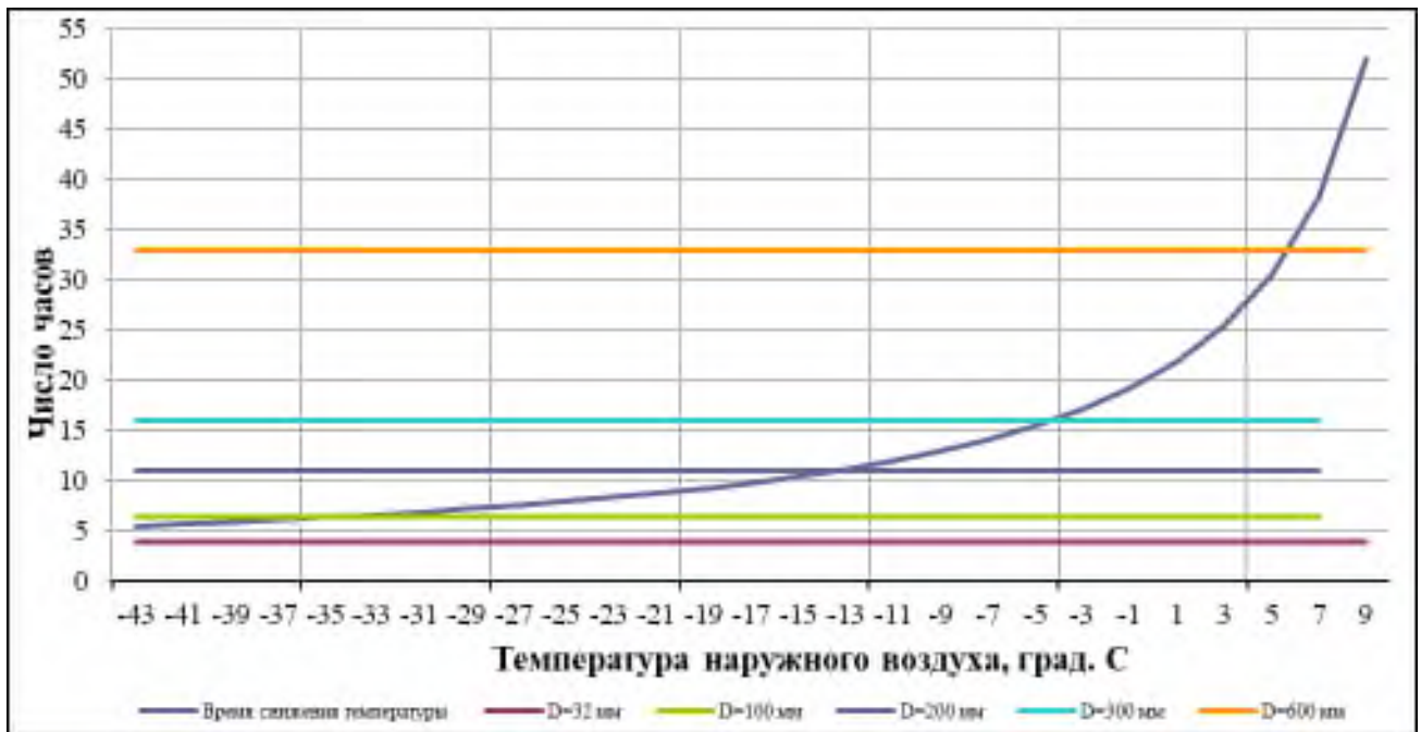
Рисунок 9 - Графическое сравнение периода времени снижения температуры внутреннего воздуха до критического значения и периода времени, необходимого для восстановления участка тепловой сети
